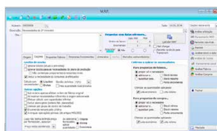
Cálculo de necessidades baseado num plano de produção ou ordens de fabrico com estado de Lançada.
